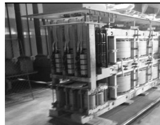
Рис.4. Фото общего вида и выемной части магнитно-вентильного управляемого реактора трансформаторного типа мощностью 25 Мвар напряжением 35 кВ. (РТУ-25000/38,5-УХЛ1).
